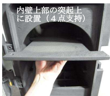
【④整流板のセット】
